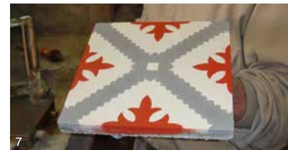
Las baldosas hidráulicas se elaboran una a una manualmente a partir de la mezcla de cemento blanco, polvo de mármol, arena, pigmentos y agua, que el artesano vierte en un molde.
